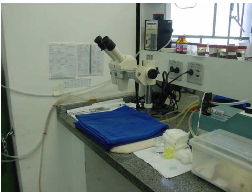
Figura 3. Bancada operatória contendo ventilador para pequenos animais (Harvard Apparatus, modelo 683), vaporizador multiagente Takaoka e estereomicroscópio Karl Zeiss
