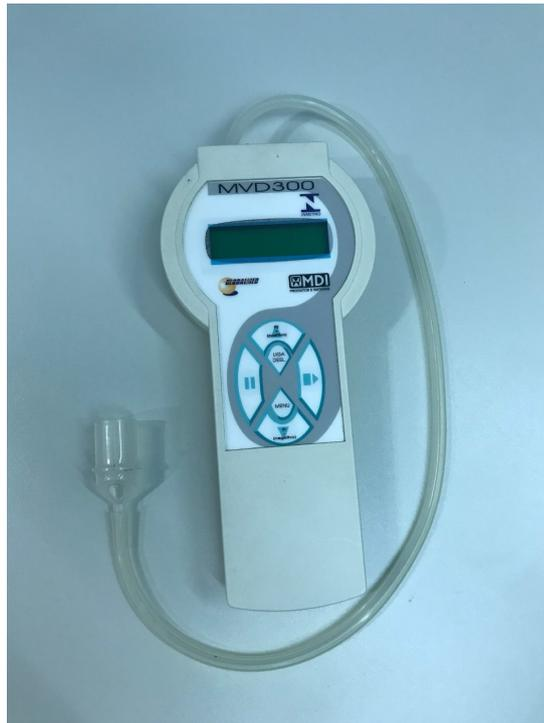
**Figura 7.** Aparelho de manovacuômetria.
