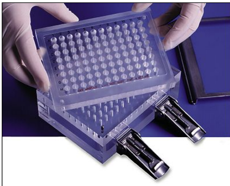
Figura 16 – Equipamento de dot blot utilizado para transferência da proteína para a membrana de nitrocelulose
